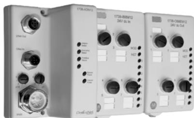
ArmorPoint es una unidad modular de E/S de 24 VCC On-Machine™ que amplía las características y beneficios del sistema E/S POINT™ IP 20 en un sistema compatible con IP 69K. E/S ArmorPoint ofrece flexibilidad, facilidad de aplicación y justo la resolución que usted necesita, de uno a ocho puntos, para reducir el costo y el tamaño del sistema. El sistema 1738 E/S ArmorPoint constituye la base de la próxima generación de productos On-Machine de Rockwell Automation.
